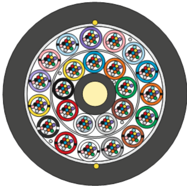
Cable Dieléctrico Estandar: 20 mm
